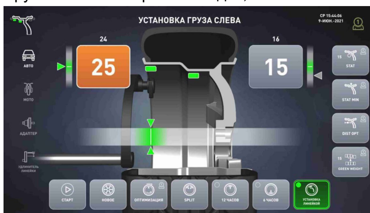
Рисунок 5.10 – Экран при установке груза линейкой
