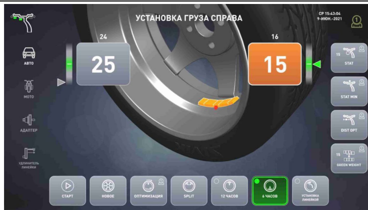
Рисунок 5.8 – Установка в «6 часов» справа
