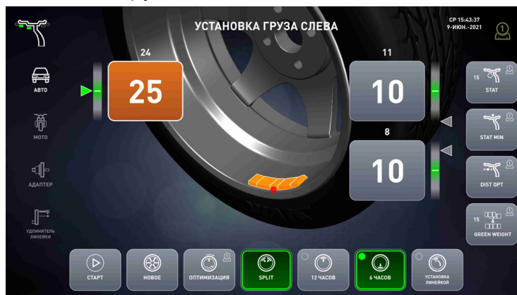
Рисунок 7.5 – Экран установки грузов в режиме Split
