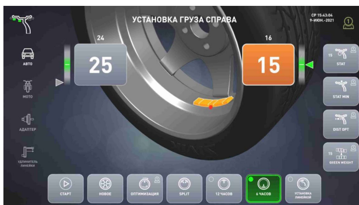
б – установка груза в «6 час»
