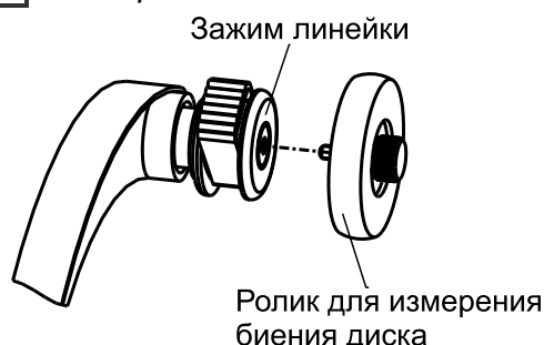
Рисунок 7.7 – Ролик для измерения биений
